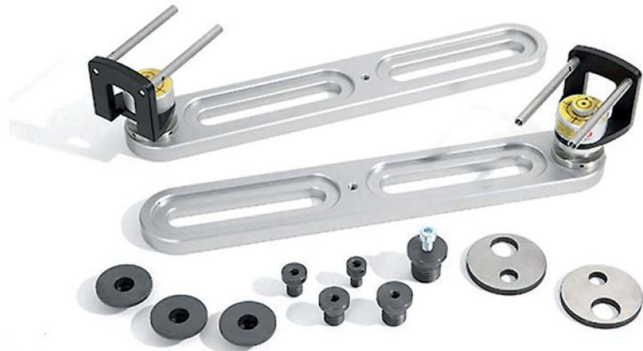
Maschinenpaare, die über Kardanwellen miteinander verbunden sind, gelten im Allgemeinen aufgrund der ausgleichenden Wirkung des Kardans als unempfindlich gegen Ausrichtfehler. Schwingungsanalysen und Erfahrungen von Profis aus der Instandhaltung, z. B. aus der Papierindustrie, beweisen aber das Gegenteil. Somit kompensiert der Kardantrieb lediglich den Parallel-Versatz, jedoch nicht den Winkelfehler.
